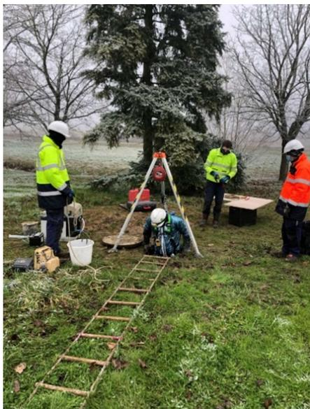
Mise en place d'un échantillonneur intégratif passif
