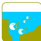
**2 : Aération** : les effluents prétraités sont brassés et aérés par des turbines ou des surpresseurs ; l'apport d'air et les durées d'aération et repos permettent de favoriser les diverses bactéries qui interviennent dans l'élimination des matières carbonées, azotées et phosphorées. La pollution se transforme en « boues ».
